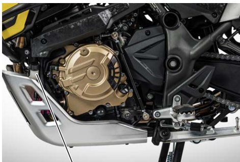
Tappo serbatoio liquido refrigerante
