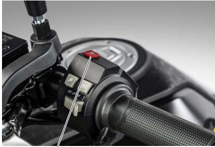
Segnalazione di emergenza "Hazard"
